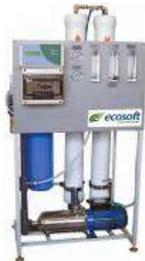
В процессе очистки воды через систему обратного осмоса серии MO MINI происходит разделение воды на два потока: деминерализованную воду - пермеат и воду с повышенным содержанием солей - концентрат. Часть концентрата сбрасывается в дренаж, а часть проходит регулирующийся рецикл, который позволит контролировать и регулировать объем сброса концентрата.
